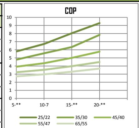
Puissance de chauffage et coefficients de performance selon EN 14511
